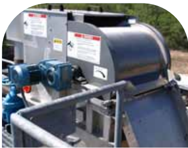
Las rejillas retienen los sólidos, la escoria y los materiales grasos sin taparse
